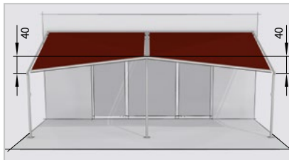
Koppelanlage mit abgesenkten Säulen (Maßangaben in cm)
